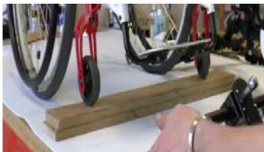
4) Setzen Sie zunächst nur eine Rahmenklemme an den Frontrahmen an. Wählen Sie hierfür entweder ein vertikales oder wenn nötig ein horizontales Rahmenrohr zur Montage aus.
