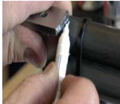
**11)** Entfernen Sie beide Kabelbinder und markieren Sie die beiden überschüssigen Rohrteile mittig. Ziehen Sie pro Seite 2mm zum Rohrbogen hin zur Erreichung einer Schiebetoleranz ab.
