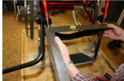
**9)** Richten Sie beide Rahmenklemmen mit Hilfe eines eingeschobenen Rohrbogens rechtwinklig zum Frontrahmen aus.
