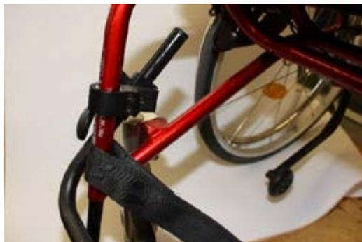
Unterlegen Sie beide Lenkräder des Rollstuhls mit nach hinten ausgerichteten Lenkgabeln durch 38-40mm MDF oder Holzplatten von ca. 10cm Tiefe und 70cm Breite.
