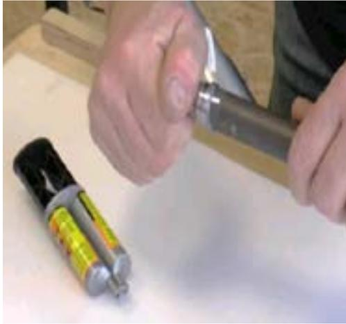
Verkleben Sie im folgenden Schritt die Gelenkstücke mit den Einschubseiten der Rohrbögen, sowie mit den gefertigten Rohrstücken zum Einschub.
