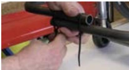
**11)** Entfernen Sie beide Kabelbinder und markieren Sie die beiden überschüssigen Rohrteile mittig. Ziehen Sie pro Seite 2mm zum Rohrbogen hin zur Erreichung einer Schiebetoleranz ab.
