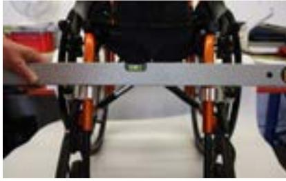
**8)** Montieren Sie nun die 2.te Klemme ebenso auf der anderen Seite des Rahmens unter Zuhilfenahme einer Wasserwaage auf der gleichen Höhe.
