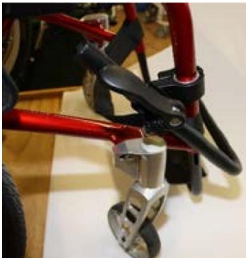
5) Setzen Sie hier nun zur Beurteilung der Position bzw. Notwendigkeit der Verwendung der Stiftpositionierung einen Rohrbogen ein.
